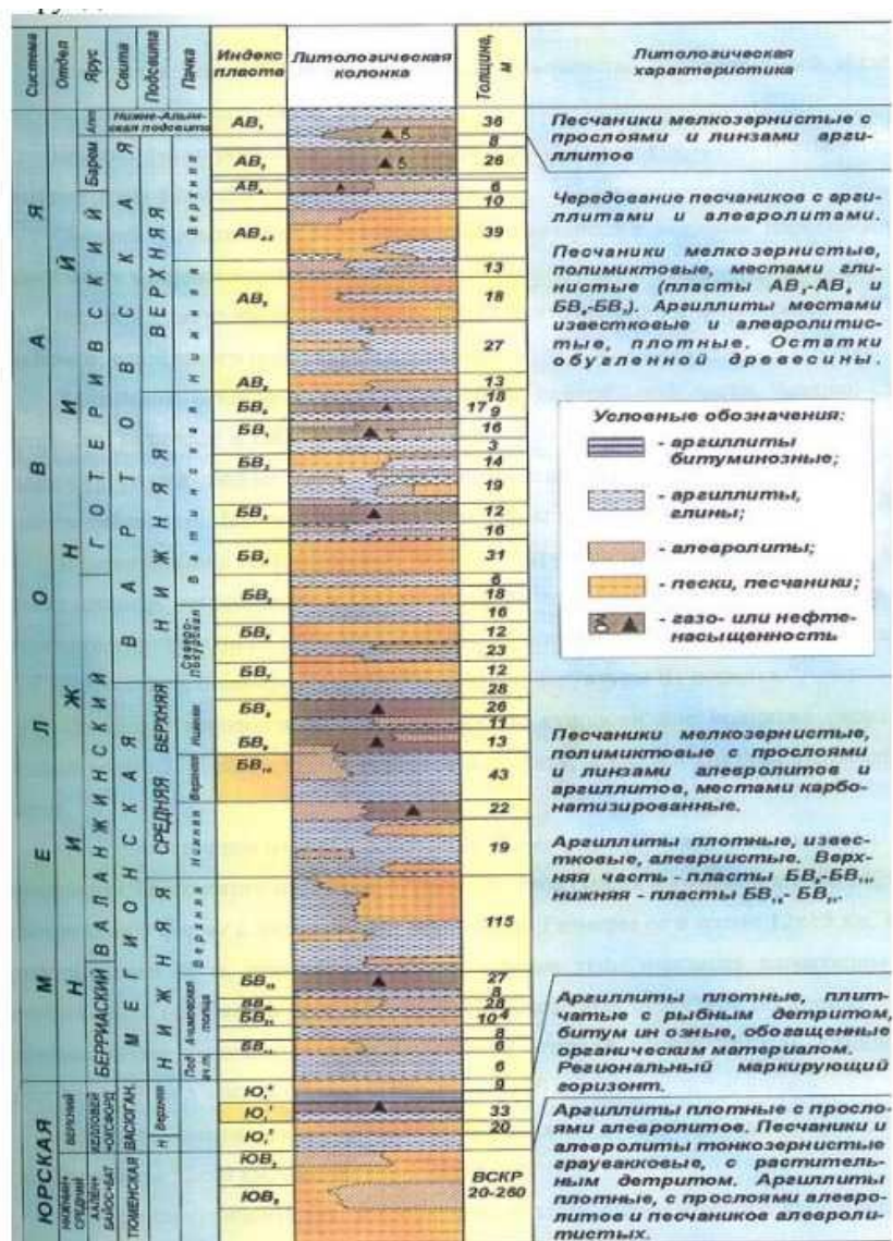
Рисунок 2.1 - Сводный литолого-стратиграфический разрез продуктивных отложений Нижневартовского свода
