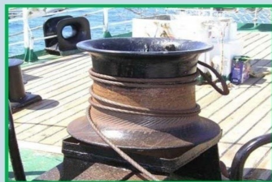
Швартовые шпиль устанавливаются для работы с кормовыми швартовыми. Они занимают мало места на палубе, привод шпилья располагается под палубой.
