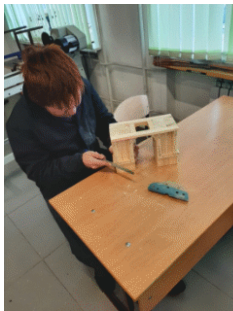
3. Разметить и вырезать из фанеры арочные элементы
