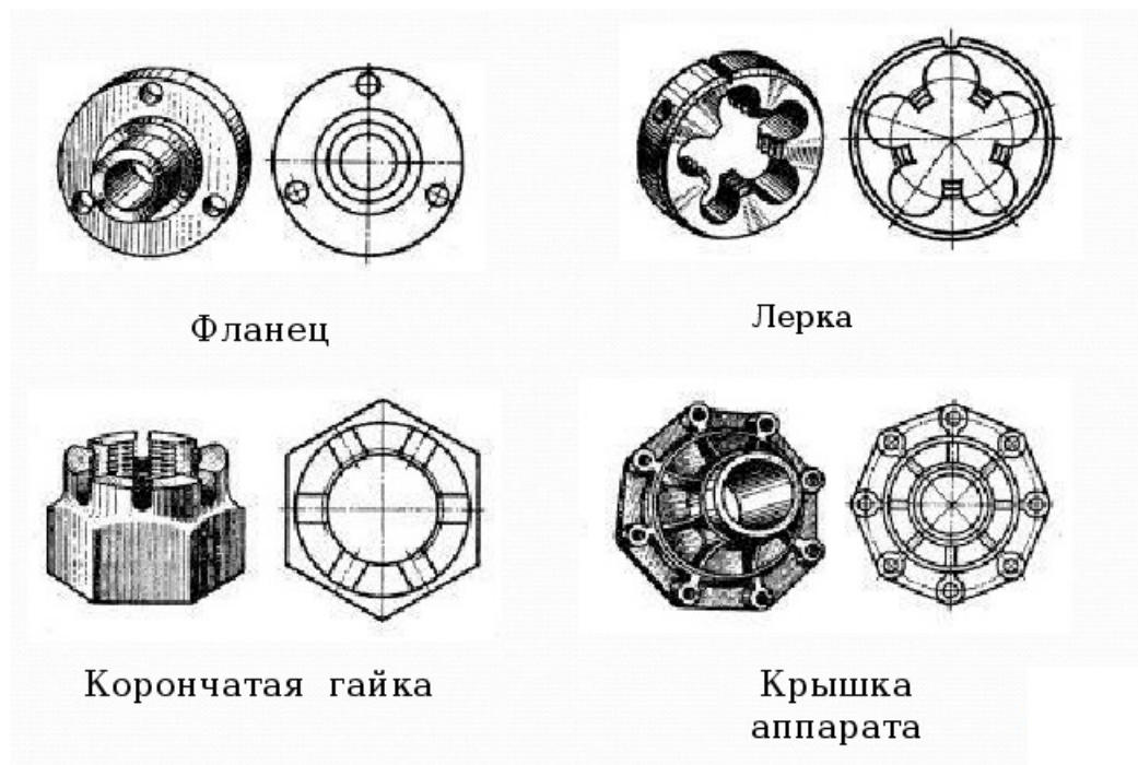
Рисунок 13-Примеры деталей с делением окружностей на равные части
